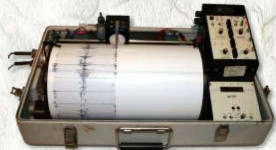
Les secousses du sol sont enregistrées à l'aide d'appareils appelés **sismographes**. Chaque sismographe comprend :
